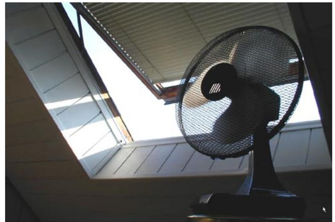
70-80°C heiß wird es im Sommer auf Dacheindeckungen - 20cm Dämmstoff und innere Speichermassen sind ein guter Schutz dagegen. Der innen liegende Sonnenschutz des Dachflächenfensters ist dagegen wenig wirksam. Er muss außen liegen.
