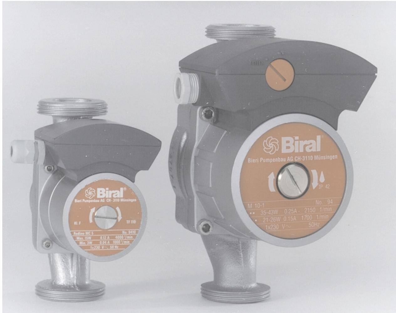
Die Pumpe (links) regelt zwischen 3-15 Watt. Bei Neubauten sind 0,1 W/m<sup>2</sup> Wohnfläche elektr. Leistung ausreichend. Die Pumpenleistung reicht für Gebäude bis 150 m<sup>2</sup> Wohnfläche.
