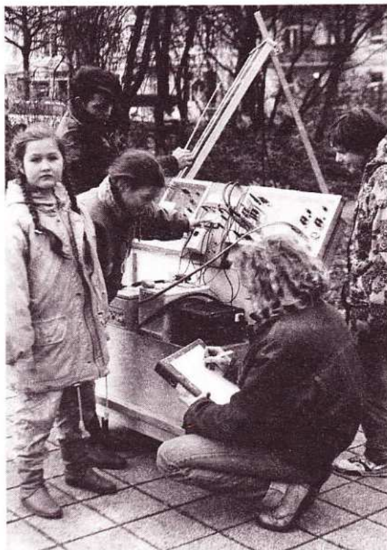
Schüler messen die Leistungsminderung der Demonstrationsanlage durch Abschattung der Solarmodule
