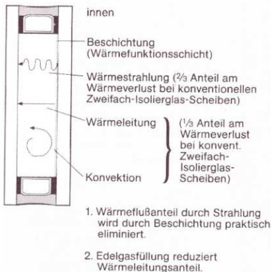
Wärmetechnische Wirkungsweise von beschichtetem Warmglas
