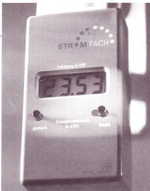
Der Strom-Tacho wurde an der ETH Zürich entwickelt und ist in der Schweiz bereits in vielfachem Einsatz.
