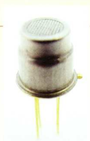
Metalloxid-Sensor zur Luftqualitätsmessung. Erst das ausgeklügelte Auswerteverfahren ermöglicht aussagekräftige Messwerte.
