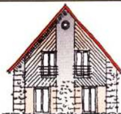
Wärmedämmung und neue Fenster (Brüstung entfernt)
