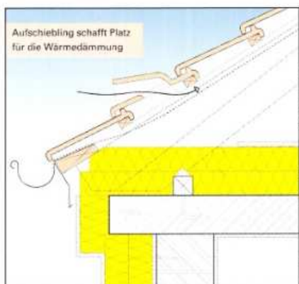
Dämmung auf dem Dachboden
