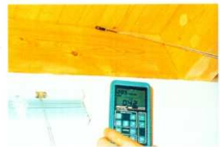
Messung mit Thermoanemometer
