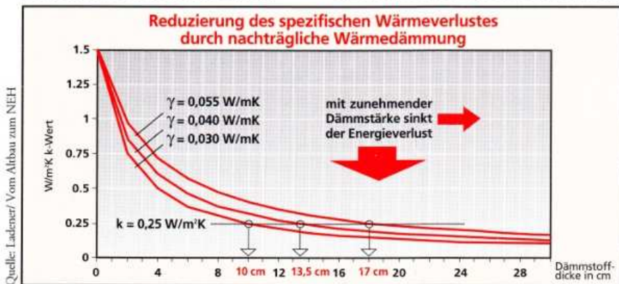
Der k-Wert in Abhängigkeit von der Dämmstoffstärke für verschiedene Dämmstoffqualitäten
