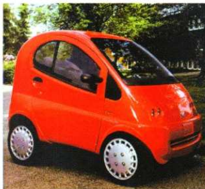
Leicht Elektro Mobil LEM „Voltaire“ von EVO-Mobile GmbH (Neuentwicklung), 45 km/h, 100 km weit, 16% Steigung, 4 kW AC-Motor, Blei-Vlies-Batterie 120 Volt, < 12 kWh/100 km, ab 16.000 €
