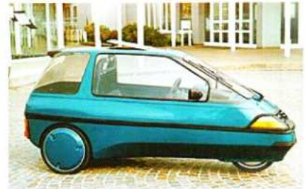
Cabin-Scooter „TWIKE“ von FINE MOBILE („Kultfahrzeug“, ca. 700 gebaut), 85 km/h, 60 km weit, 20% Steigung, 5 kW AC-Motor, NiCd-Batterien 260 Volt / 2 oder 3 kWh, < 5 kWh/100 km, ab 14.000 €
