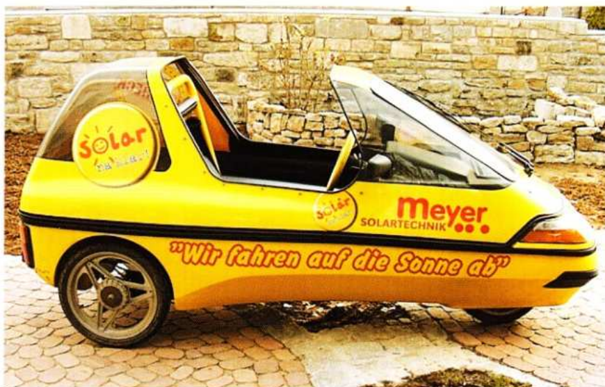
Cabin-Scooter „CITYEL“ von CITYCOM AG (über 5.000 gebaut), 50 km/h, 60 km weit, 16% Steigung, 2,5 kW DC-Motor, verschiedene 36 Volt-Bleibatterien, < 7 kWh/100 km, 6.600 €, für Mitglieder günstiger.
