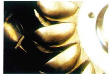
Kein Schaufelradbagger, sondern die Leitschaufel einer Gugler-Turbine
