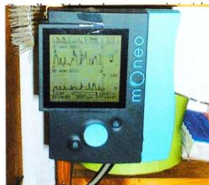
Der Moneo kann zwei Messwerte stundenweise bis zu einem Jahr speichern. Hier erkennt man im gezoomten Darstellungsmodus Strom und Gasverbrauch der letzten fünf Tage.
