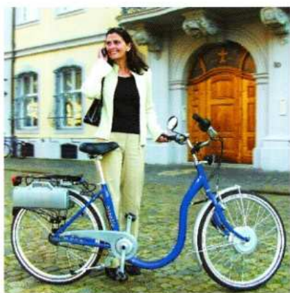
Elektro-Fahrrad „estelle-city“ von Fa. Heinzmann, 22 km/h, 30 km weit, 9% Steigung, 250/500 Watt-DC-Motor, NiCd-Batterie 36 Volt, 1.689 €
