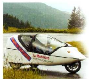
Cabin-Scooter „CITYEL“ von CITYCOM AG (über 5.000 gebaut), 50 km/h, 60 km weit, 16% Steigung, 2,5 kW DC-Motor, verschiedene 36 Volt-Bleibatterien, < 7 kWh/100 km, 6.600 €
