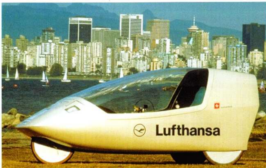
Cabin-Scooter „TWIKE“ von FINE MOBILE („Kultfahrzeug“, ca. 700 gebaut), 85 km/h, 60 km weit, 20% Steigung, 5 kW AC-Motor, NiCd-Batterien 260 Volt / 2 oder 3 kWh, < 5 kWh/100 km, ab 14.000 €
