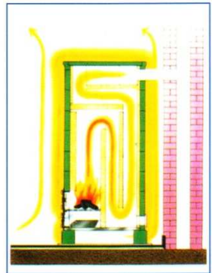
Die Verbrennungsgase durchströmen den Ofen und erwärmen die Schamottesteine.
