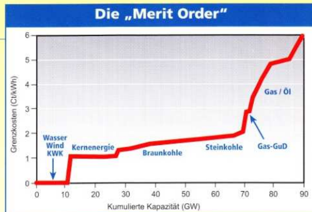
Die Zusatzkosten einer Mehrproduktion bestimmen die Einsatzreihenfolge von Kraftwerken, in Cent/kWh
