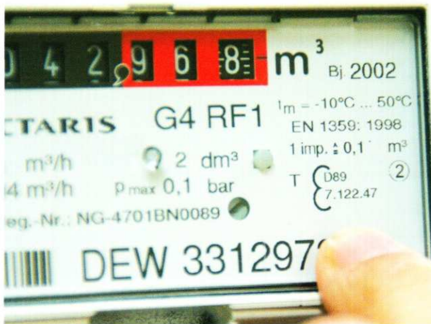
Typenschild eines in der EU zugelassenen Balgengaszählers. Jahr der Zulassung durch die Physikalisch Technische Bundesanstalt: 1989, Zulassungsnummer: 7.122.47
