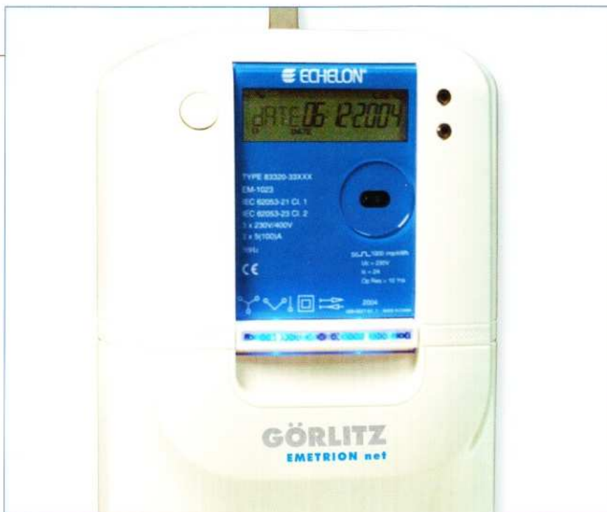
Echolon-Zähler sendet Messdaten über das Stromnetz.
