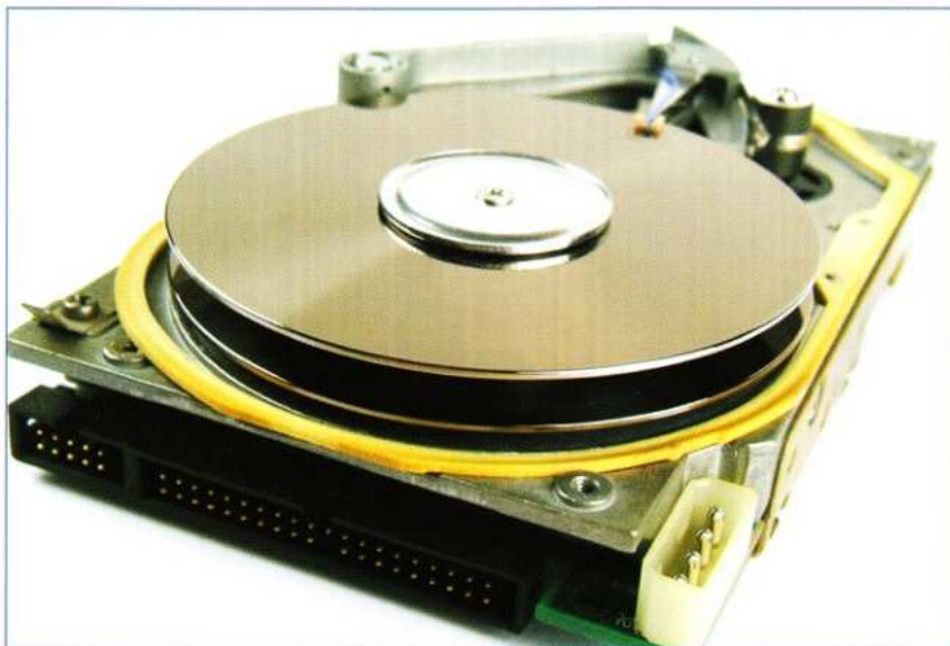
Drehzahl und Scheibenzahl erhöhen den Stromverbrauch einer Festplatte
