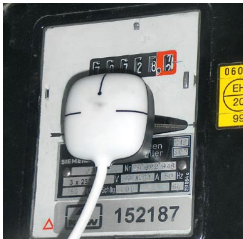
Leicht zu montieren: Der Wattcher beobachtet ständig, wie schnell sich die Zählerscheibe dreht.
