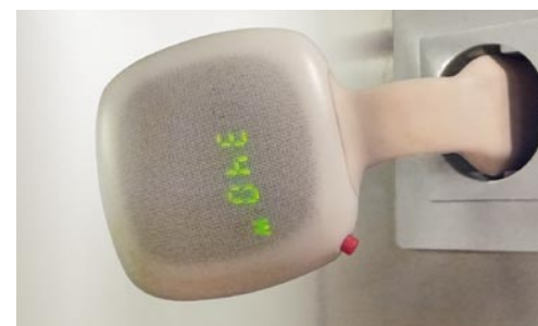
Das Wattcher Energie-Anzeigergerät beobachtet den Stromzähler – die momentan bezogene Leistung kann an jeder Steckdose sichtbar gemacht werden
