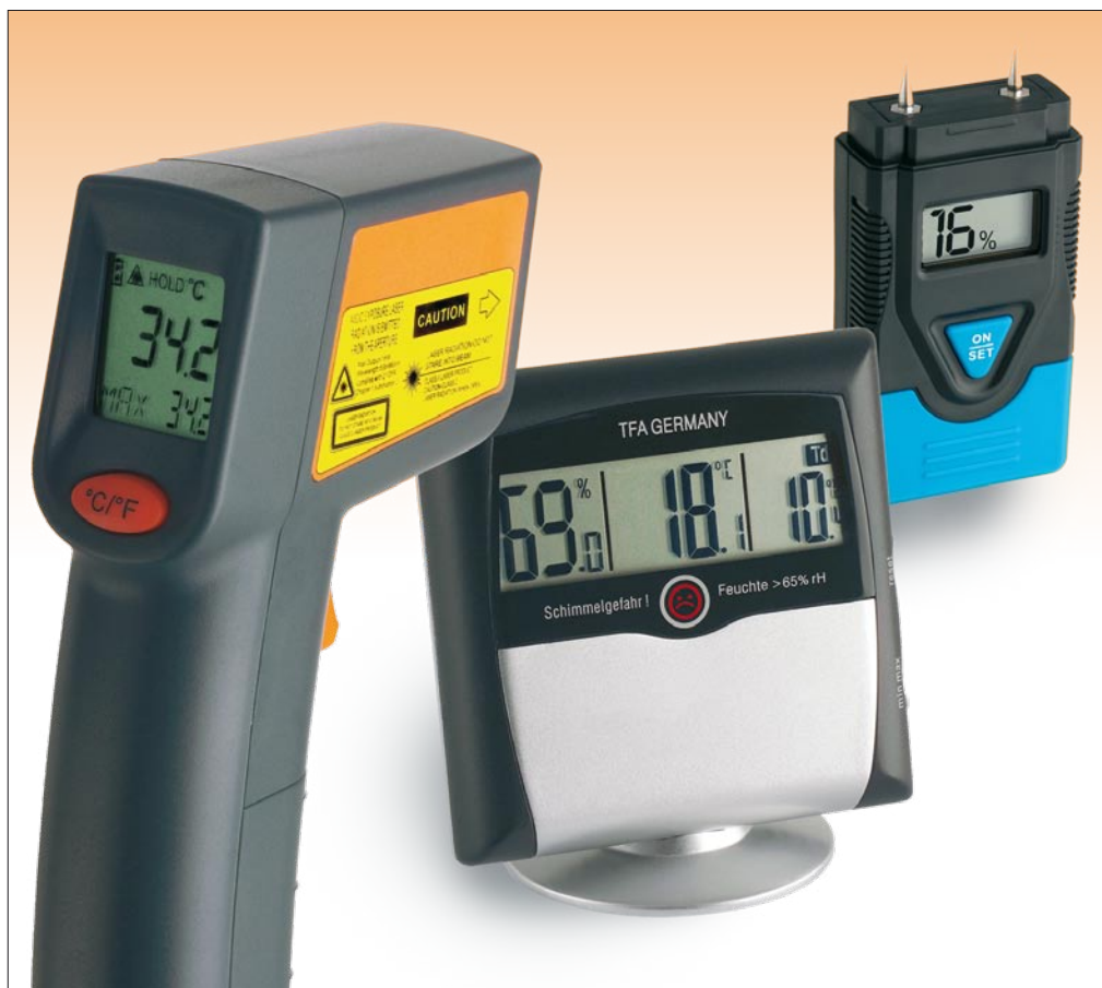
Das Risiko im Blick mit der Anti-Schimmel-Box: Mitglieder können es kostenlos ausleihen. Scantemp 380 Infrarotthermometer, digitales Thermo-Hygrometer Comfort Control, Humidcheck Mini Materialfeuchte-Messgerät. Mit freundlicher Unterstützung der Firma TFA Dostmann.
