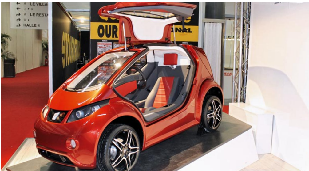
Colibri ist eine Entwicklung der TU Chemnitz und wird von der Innovativ Mobility Automobil in Jena für die Serienproduktion im Jahr 2015 vorbereitet. Er soll 10.000 Euro kosten plus Batterie-Leasing. Der Einsitzer wiegt 440 kg, ist 1,14 m breit und soll eine Reichweite von 110 Kilometern haben und bietet Platz für zwei Getränkekisten und eine Tasche.
