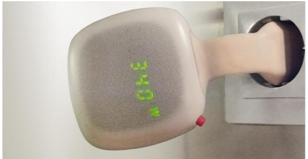
Der Wattcher beobachtet den Stromzähler – die momentan bezogene Leistung kann an jeder Steckdose sichtbar gemacht werden
