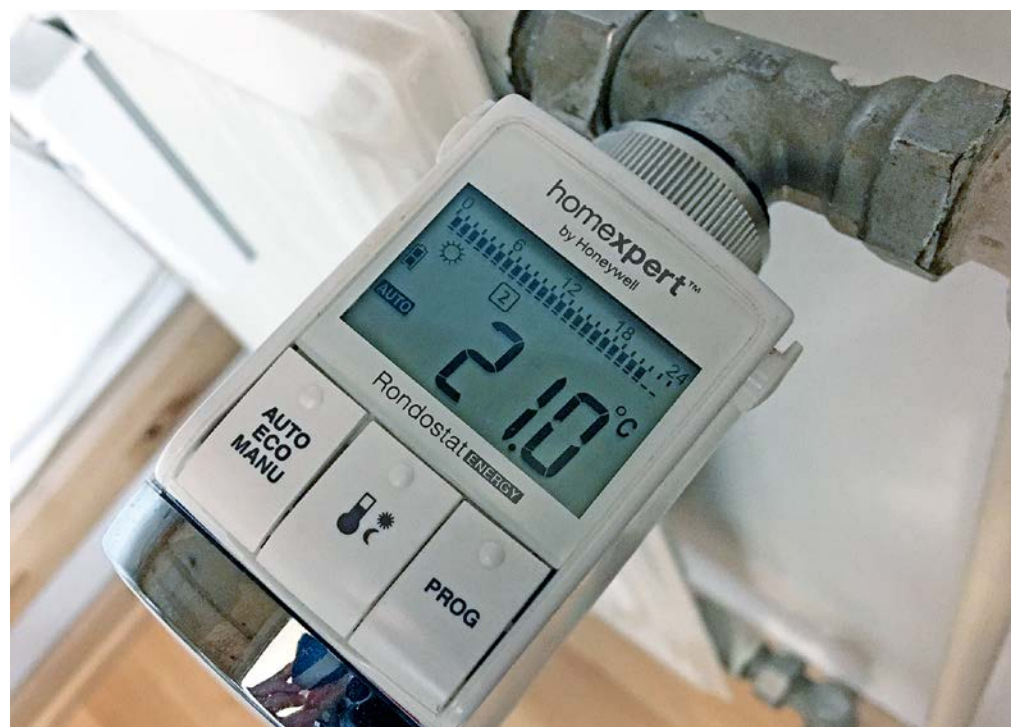
Einfach, preiswert und mit einem Handgriff auch in Mietwohnungen angebracht: Elektronisches Heizkörperthermostat „Honeywell HR25“ mit bis zu drei Absenkephasen pro Tag und auf 0,5 °C genauer Einstellmöglichkeit.
