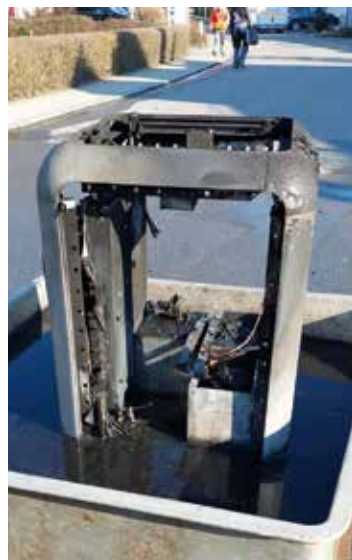
Bilder des Einsatzes der Feuerwehr Bodnegg zeigen, wie ein brennender Stromspeicher nach erfolglosen Löscharbeiten durch Untertauchen in Wasser gesichert wird.
