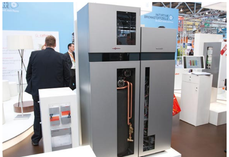
Viessmann Vitocalor 300-P mit Panasonic-Brennstoffzelle, 750 Watt elektrische Leistung als kompakte Heizungs-Energiezentrale mit Warmwasserbereitung für Ein- und Zweifamilienhäuser.
