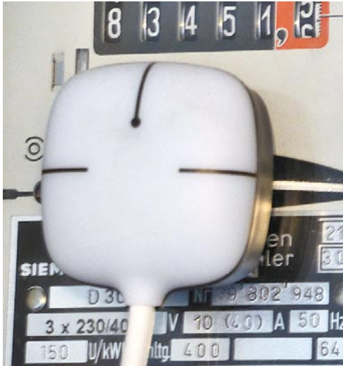
Der Wattcher ist den Lesern aus früheren Heften bekannt. Wenn Stromzähler in Zählerschränken verschlossen sind, kann der Wattcher nicht montiert werden.
