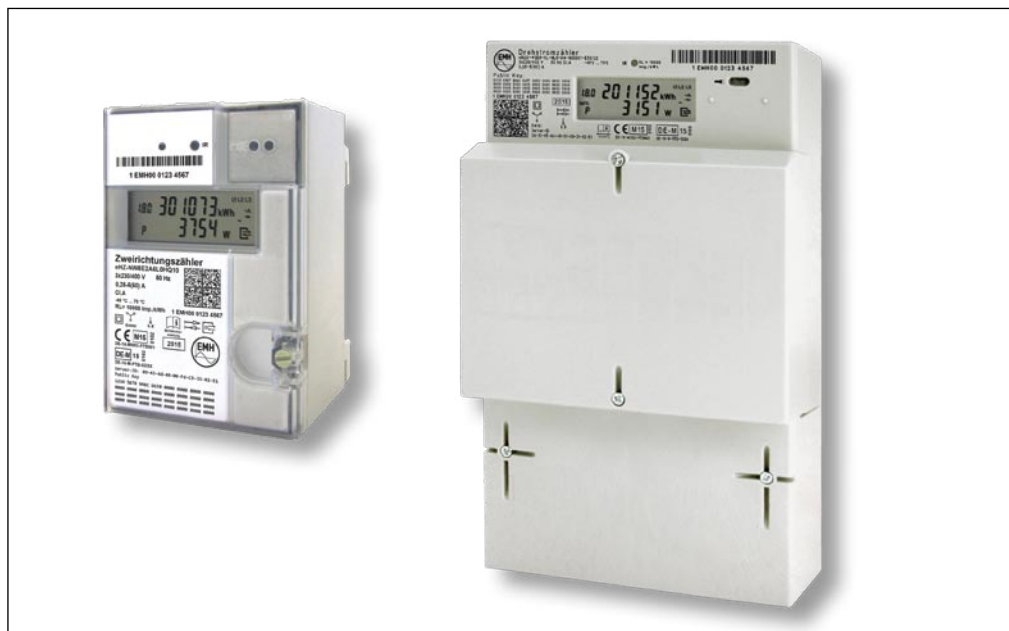
Intelligente Basiszähler „iZ“ in BKE-Bauform (links) sind von heute üblichen „eHZ“ nach EDL21-Standard äußerlich kaum zu unterscheiden, unterstützen aber die Kryptografie des MessSystems 2020. Größere Basiszähler (rechts) verfügen über eine Klappe, hinter der sich ein Smart-Meter-Gateway installieren lässt, das mehrere iZ zu einem Messsystem „iMSys“ aufwerten kann.
