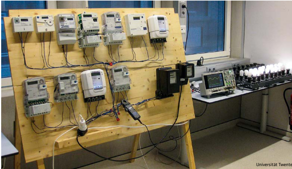
Messaufbau der Universität Twente: Alle elektronischen Zähler sowie auch die beiden analogen Kontrollzähler wurden in Reihe geschaltet. Dementsprechend müssten alle Zähler, wenn sie richtig messen, den gleichen Verbrauch ermitteln – was jedoch nicht der Fall war.
