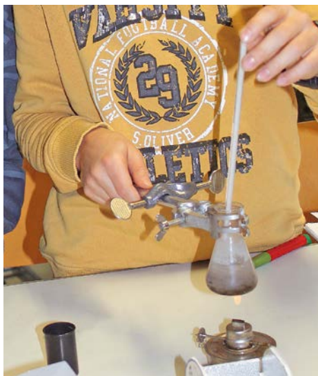
Das Heizungswasser wird mit einem Spiritusbrenner als Kesselsatz auf 80 °C erhitzt.
