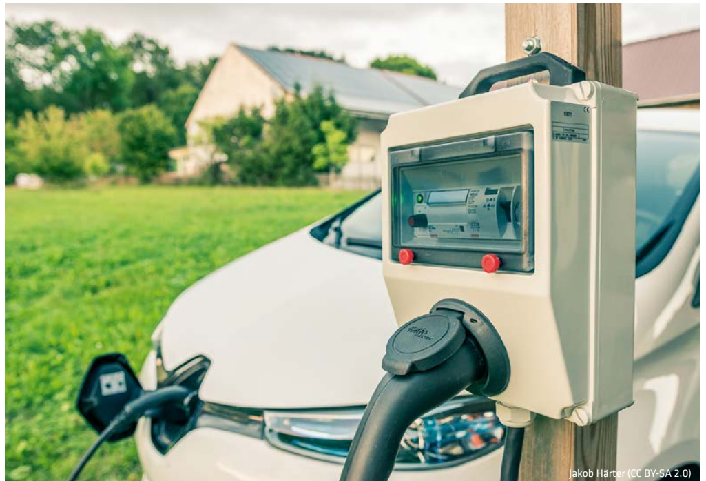
Eine Wallbox für Daheim gibt es in stylischen Gehäusen oder auch ganz zweckmäßig. In diesem Beispiel kann der Ladestrom über einen Drehschalter gewählt werden. Möglich ist auch eine automatische Ladestromanpassung gesteuert durch den Ertrag der eigenen PV-Anlage.
