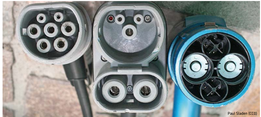
Serienmäßig kommen E-Fahrzeuge mit einem Typ-2-Stecker (links). Beim CCS-Stecker wird dieser unten um Gleichstrom-Schnellladekontakte ergänzt (mittig). Eine Sonderrolle nimmt der bei den Fahrzeugen asiatischer Automarken häufig anzutreffende CHAdeMo-Stecker ein, der an deutschen Ladestationen nicht sehr verbreitet ist (rechts).
