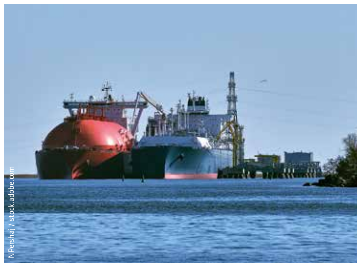
LNG-Tanker bei der Entladung im Hafen von Klaipėda unter Nutzung eines schwimmenden LNG-Terminals (FSRU) zur Einspeisung in das litauische Erdgasnetz
