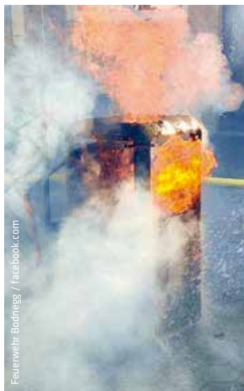
Bilder des Einsatzes der Feuerwehr Bodnegg zeigen, wie ein brennender Stromspeicher nach erfolglosen Löscharbeiten durch Untertauchen in Wasser gesichert wird.
