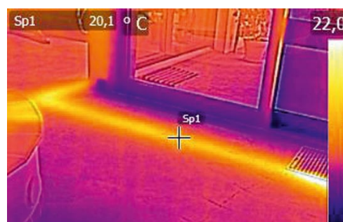
Heizungsrohr verläuft knapp neben der Reparaturfuge
